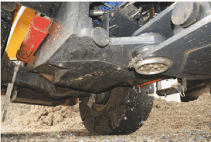
Maszyna została wyposażona w dodatkowe osłony podwozia i przegubu, które chronią przed wnikaniem kłopotliwych odpadów, np. w postaci sznurków czy drutów.
