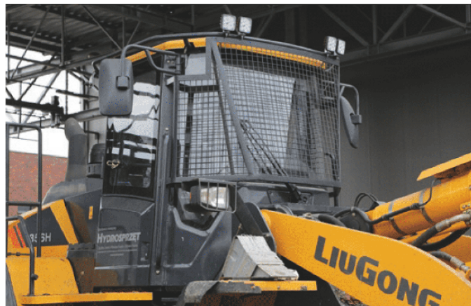
Przy wysokim operowaniu ładunkiem zawsze może coś wypaść z łyżki. Aby nie doszło do stłuczenia szyby i reflektorów, elementy te zostały zabezpieczone osłonami siatkowymi.
